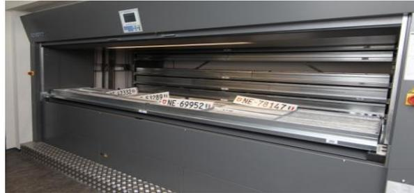
Armoire de stockage dynamique des 30'000 jeux de plaques autos sur une hauteur équivalente aux 2 étages du bâtiment. Les plaques sont protégées sous enveloppe plastique.
